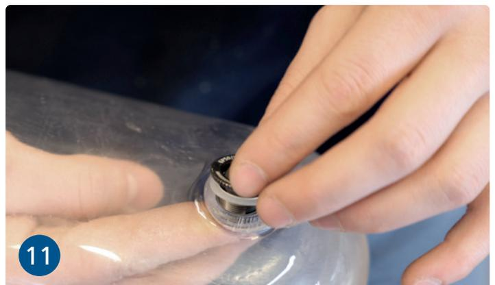
11 Ventil von innen einsetzen und von außen verschrauben. Zwischen Schaft und Ventil muss sich jeweils ein Dichtungsring befinden.
