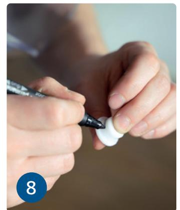
8 Für bessere Sichtbarkeit, kann die Nut im Dummy mit einem feinen Filzstift markiert werden.
