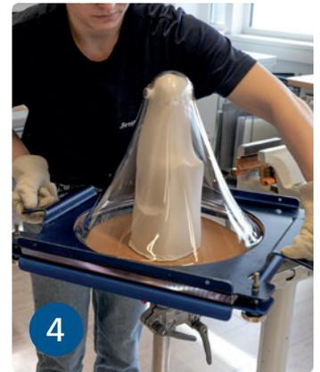
4 Erwärmtes Material über Gipsmodell und Dummy tiefziehen.
