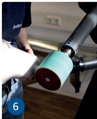
6 Den Dummy bis zur Schraube freischleifen.
