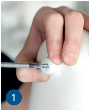
1 Der Ventil-Dummy benötigt eine plane Auflagefläche und muss fest verschraubt werden.
